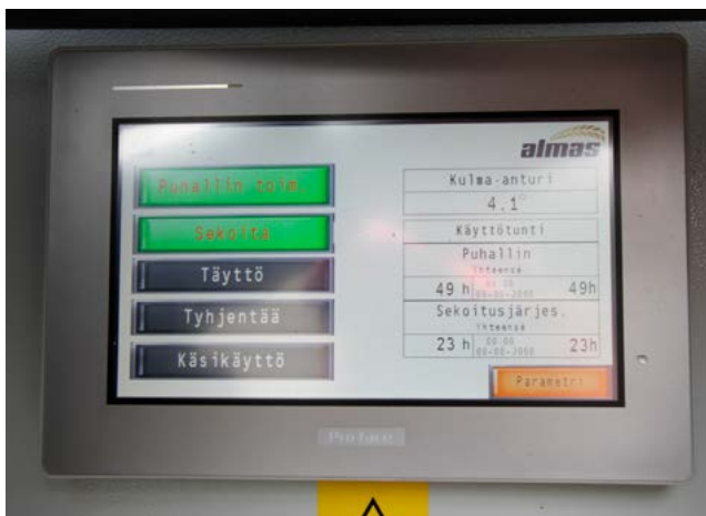
Automātiskā kaltēšanas programma tiek izvēlēta no skaidra skārienekrāna.
